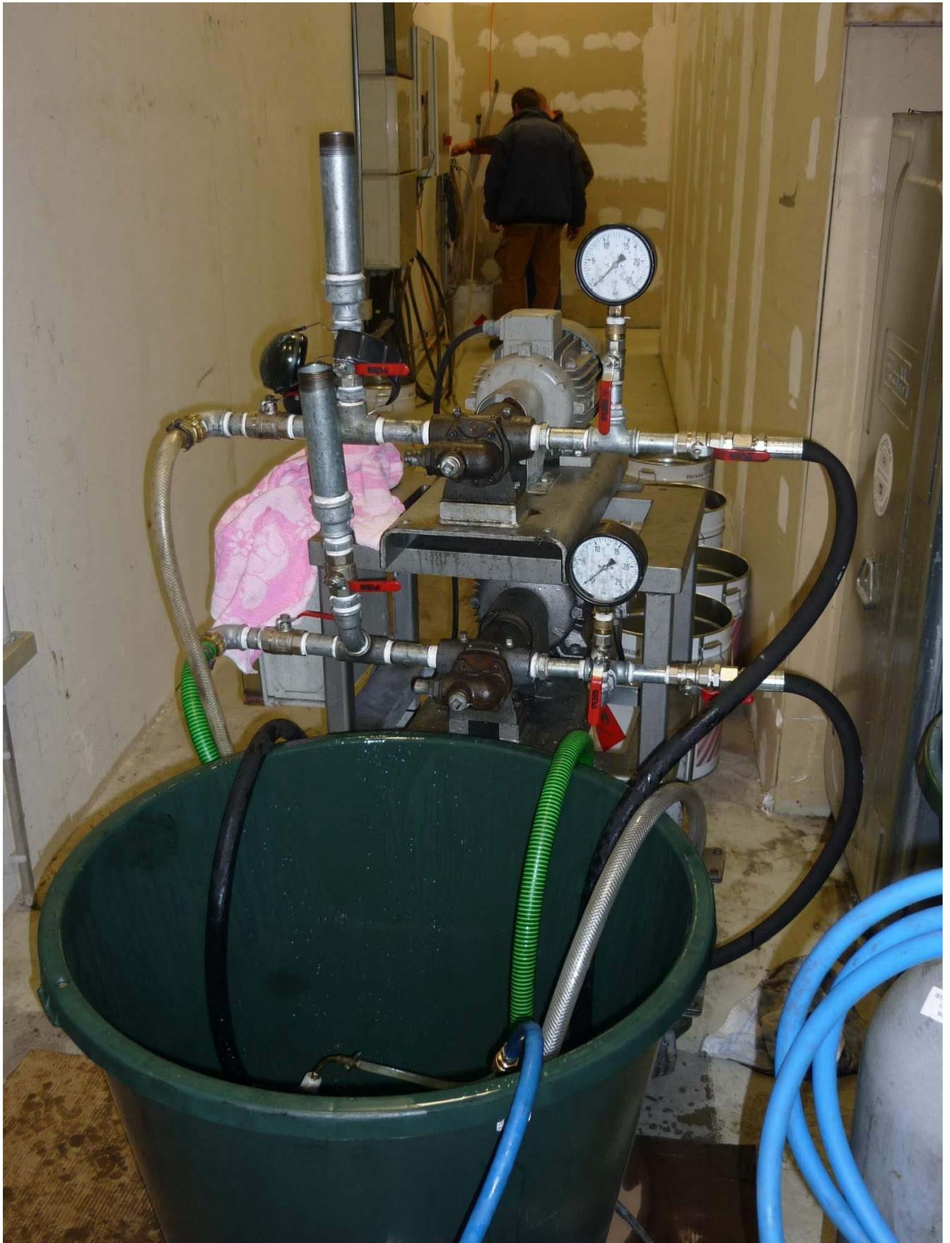
Bild 3: Vorlagebehälter mit Pumpsystem zur Herstellung des egm-Kraftstoffes
