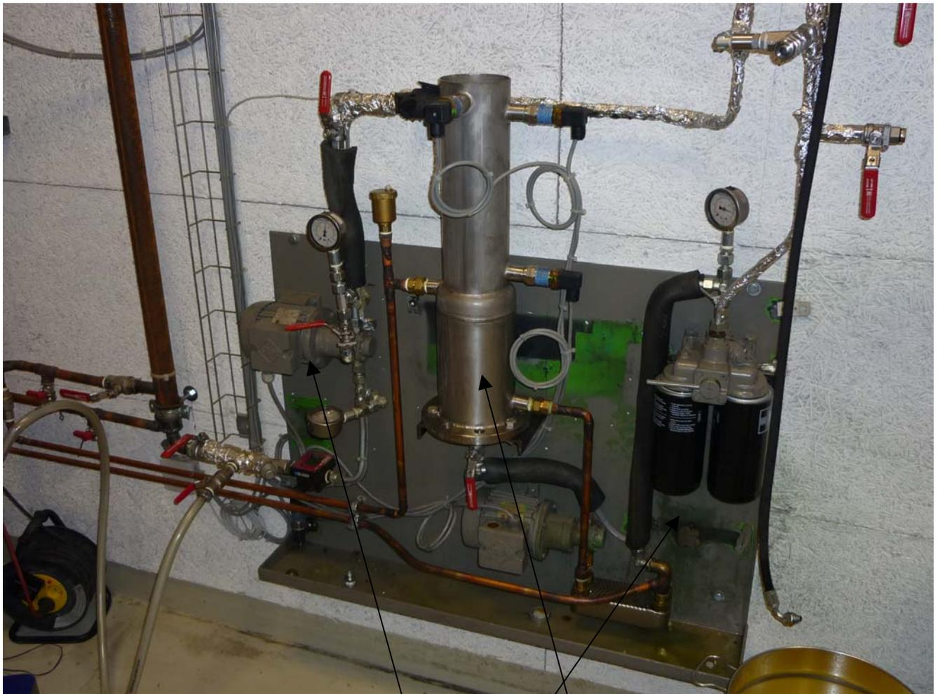
Bild 9: Kraftstofffördereinheit mit Kraftstoffpumpe, Vorwärmung (Kupferrohre zur Warmwasserversorgung) und Kraftstofffilter.
