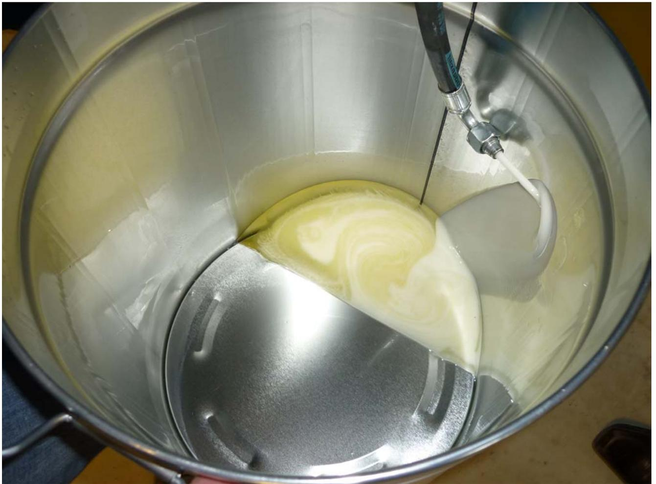
Bild 11: Spülen der Kraftstoffleitung; das gesamte Leitungssystem wurde mit den jeweiligen Kraftstoffen gespült. Im Bild ist die Probenahmestelle an der Kraftstoffrücklaufleitung zu sehen.
