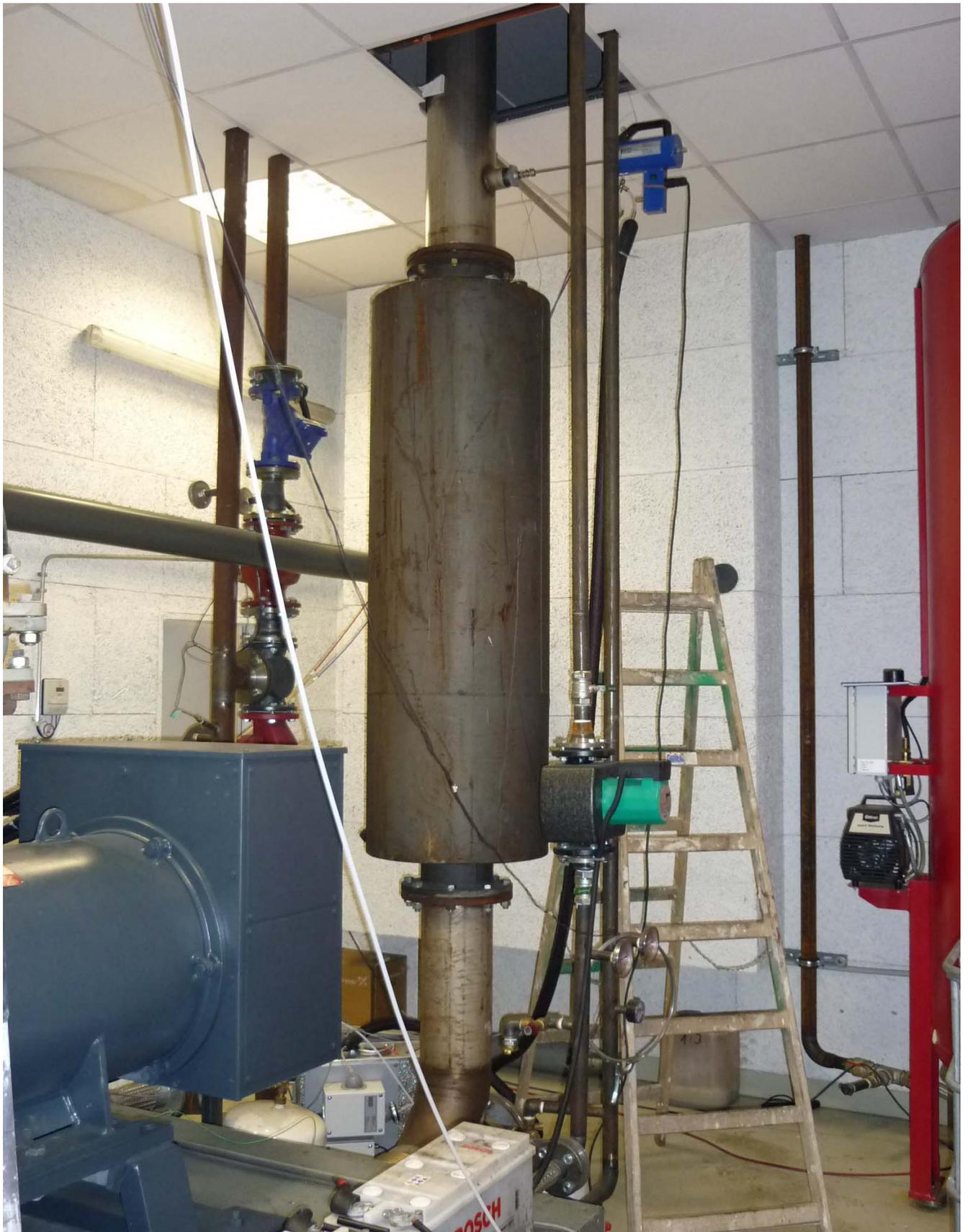
**Bild 14:** Probenahmestelle zur kontinuierlichen Ermittlung der Luftschadstoff-Konzentrationen sowie Abgasvolumenstrom
