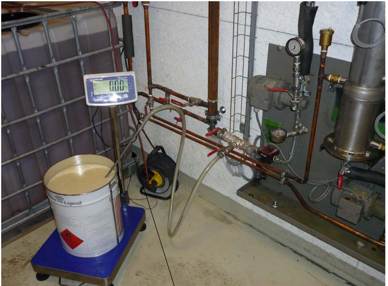
**Bild 8:** Ansicht des Kraftstoff-Aufgabesystems in die Kraftstofffördereinheit (Der Verbrauch an egm-Kraftstoff wurde mit einer Waage bestimmt)
