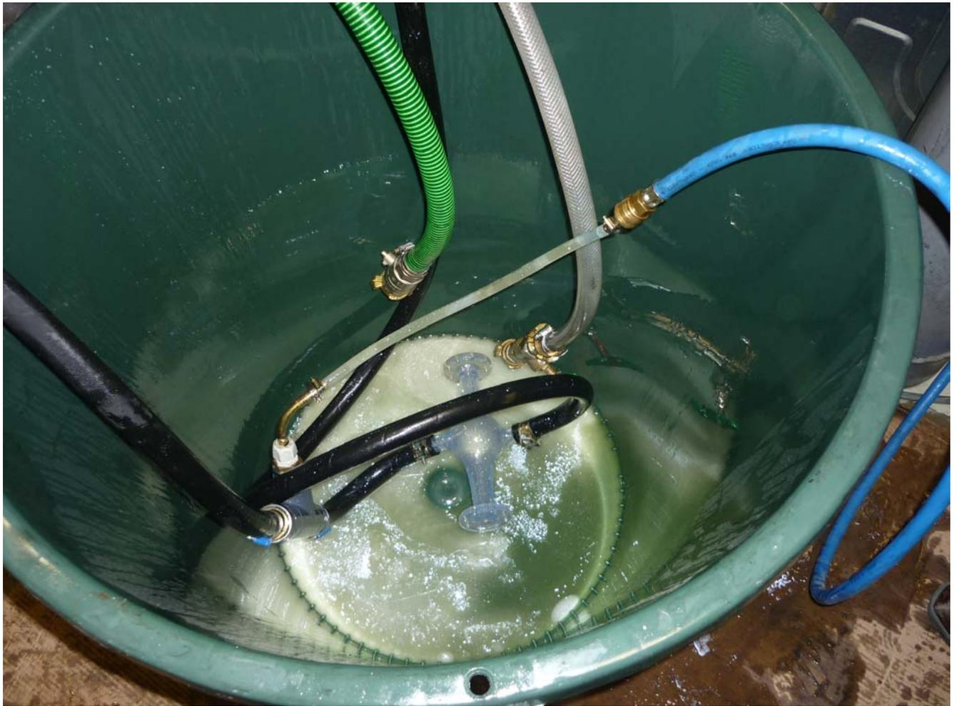
Bild 2: Vorlagebehälter mit Wirbelwandler zur Herstellung des egm-Kraftstoffes
