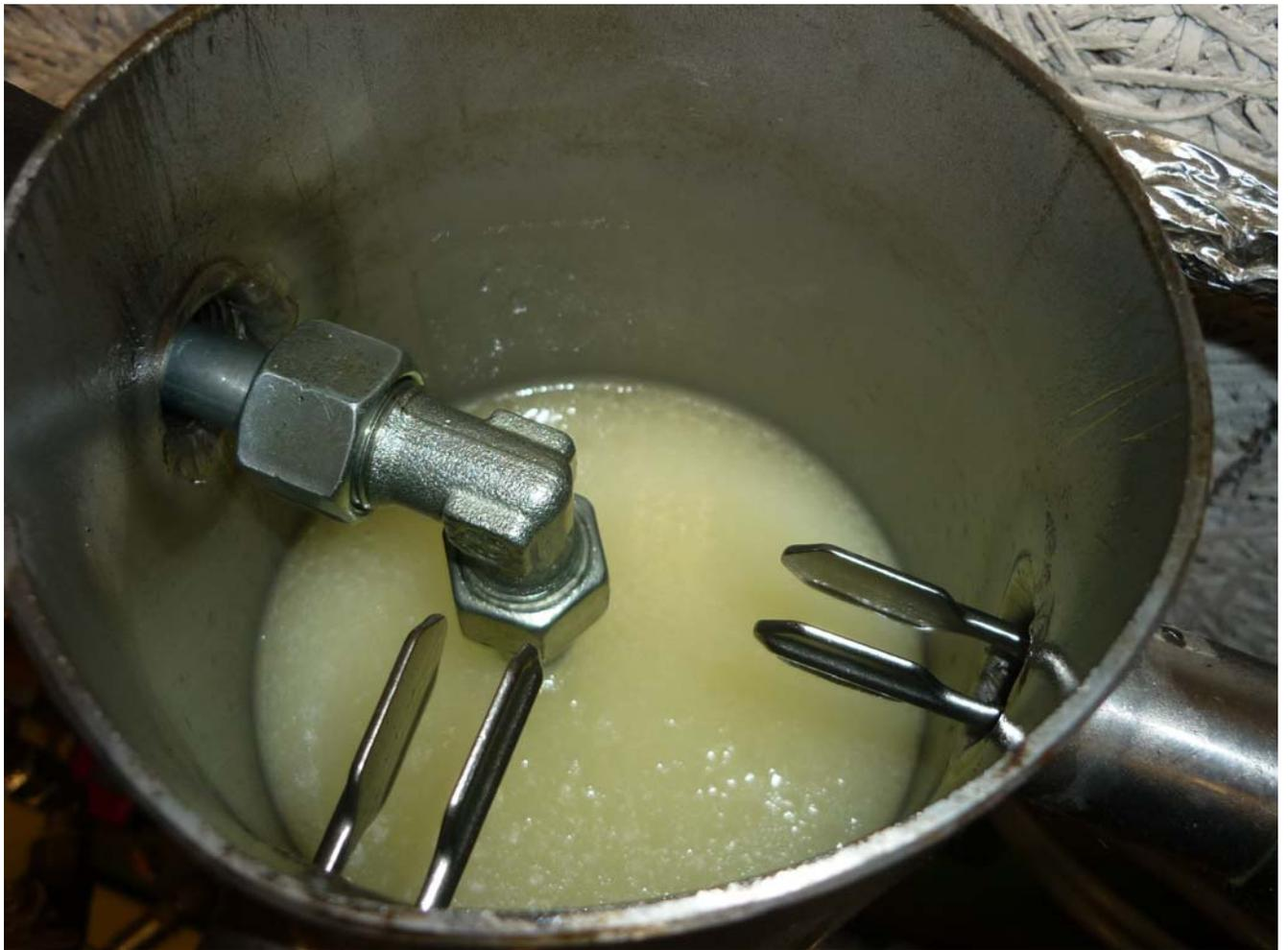
Bild 10: Detailansicht Kraftstofffördereinheit; hier Blick in den offenen Vorwämer mit dem Einfüllrohr (links) und den beiden Füllstandskontakten
